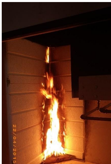
Rys. 8.1. Widok próbki wykonanej z MW i farby natryskowej w trakcie badania SBI – klasa reakcji na ogień D, s1-d0
