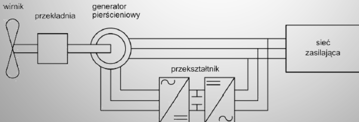
Turbina wiatrowa z maszyną indukcyjną dwustronnie zasilaną
