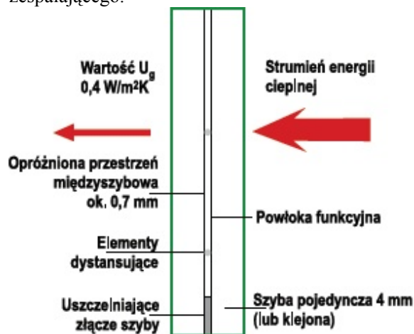
Rys. 6.1. Budowa szyby zespolonej w technologii vacuum [6]
