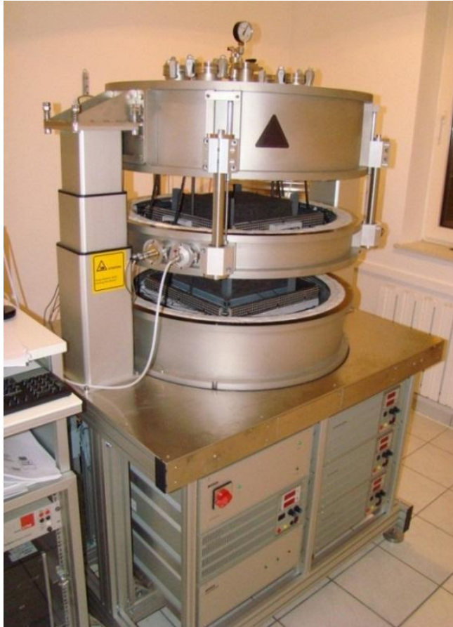
Fot. 1 Aparat z osłoniętą płytą grzejną GHP 456 Titan (zakres temperaturowy T_{\text{mean}} = -160\text{ }^{\circ}\text{C} do 700\text{ }^{\circ}\text{C} ) do pomiarów wyrobów płaskich
