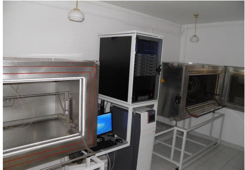
Fot.2 Aparat do pomiarów współczynnika przewodzenia ciepła wyrobów rurowych (zakres temperaturowy T_{\text{mean}} = -40\text{ }^{\circ}\text{C} do 600\text{ }^{\circ}\text{C} )
